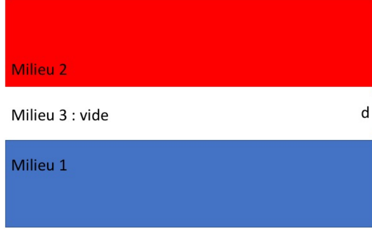
Figure 11: Deux matériaux semi-infinis (1 et 2) séparés par un milieu 3 (vide) de distance d .
